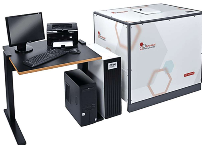
Figura 6 - RMN EFT-90 MHz com mesa de operação dedicada, incorporando conexões elétricas e de rede embutidas.
