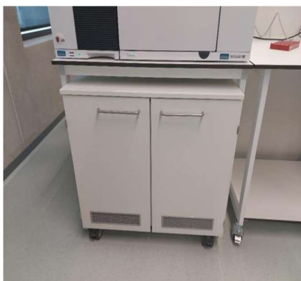
Figura 1 - Modelo de compartimento com isolamento acústico e exaustão apropriada para abrigar bombas de vácuo dos equipamentos de espectrometria de massas.
